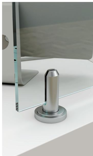
Soluzione semplice per realizzare schermi divitori in vetro di maggiore ampiezza estremamente stabili che, utilizzando vetri stratificati e temperati di spessore fino a 12,76 mm, necessitano del fissaggio sui ripiani dei banchi e delle scrivanie. Non richiede lavorazione del vetro.
